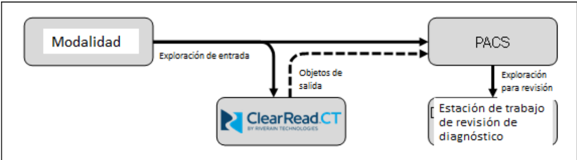
Figura 8: Flujo de trabajo de visualización típico con ClearRead CT
